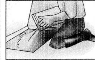
7 Echar la solución de cloro en el reservorio y dejar que se alcance el volumen estimado para llenar las tuberías
