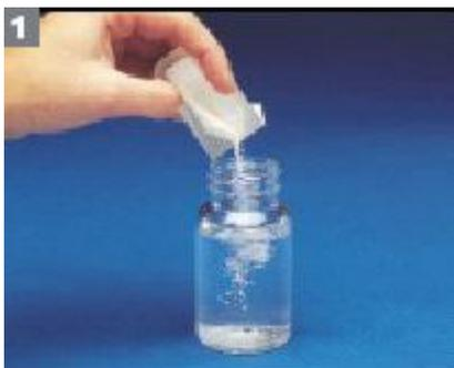
Vaciar el contenido de un sobre con el reactivo Colilert en el envase plástico con 100 ml. de muestra.
