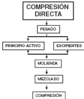
Figura No. 17. Proceso de Compresión Directa:
