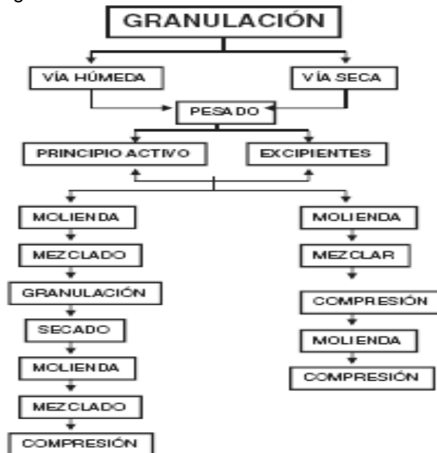
Figura No. 18. Diagrama de Granulación:
