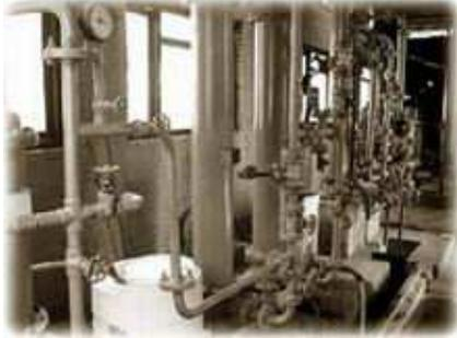
Gracias a un diseño ingenioso que utiliza la física del intercambio de calor, el mosto es separado en sus vapores constituyentes ("analizado") en el analizador y los vapores son condensados selectivamente ("rectificado") en el rectificador.
