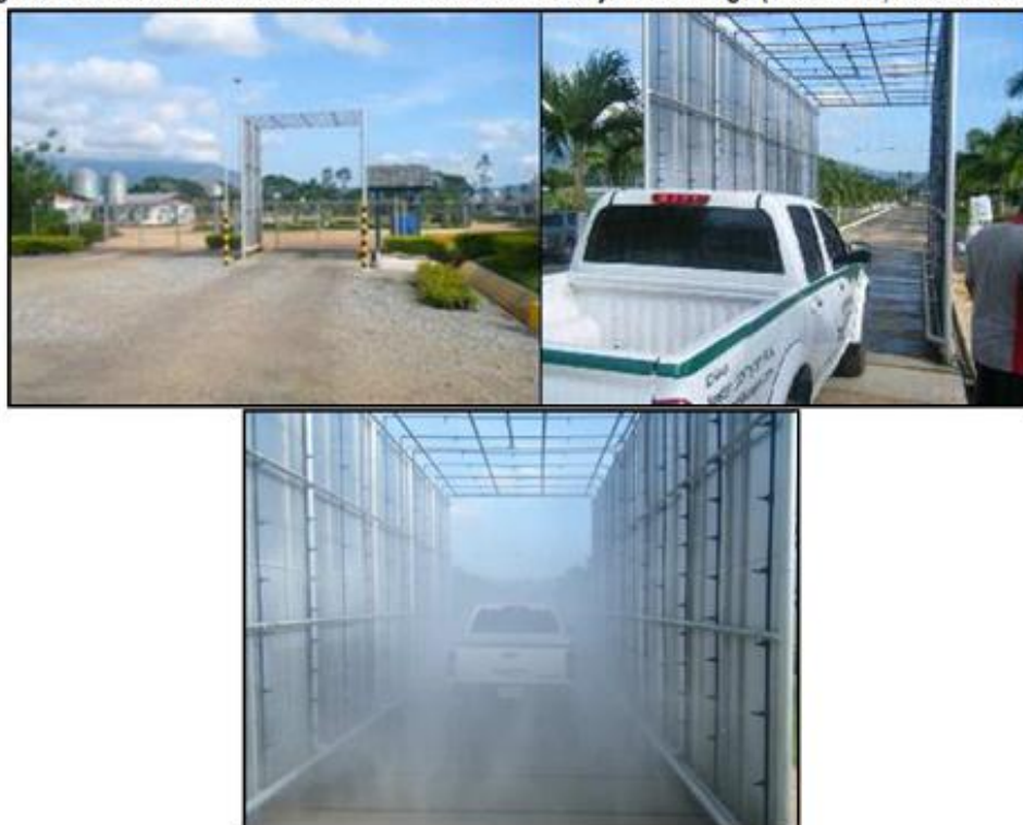
Figura 2. Arco de desinfección en funcionamiento. Granja Covadonga (Venezuela, Edo Carabobo).
