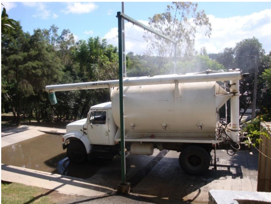
Fotografía 4 Túnel de desinfección de vehículos.
