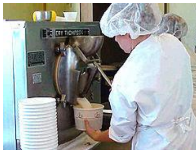
Fotografía 2: Llenado de envase primario
