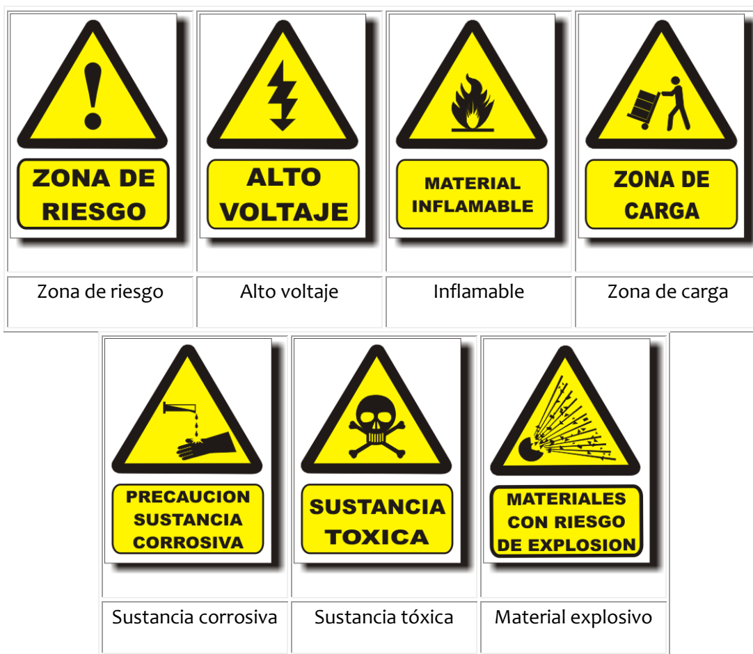
Figura No. 12: Señalamientos de Advertencia de Peligro o Riesgos
