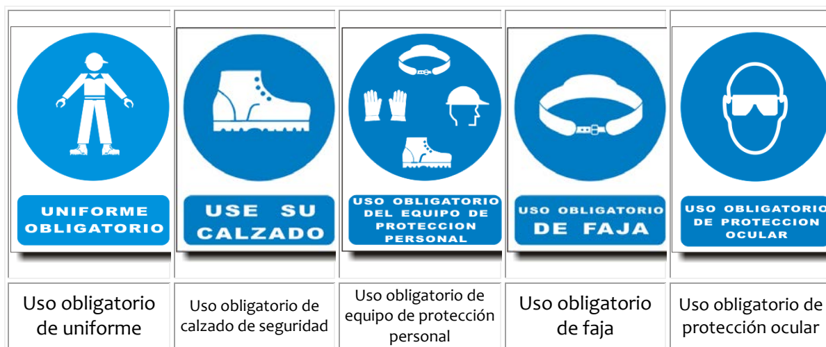
Figura No. 13: Señalamientos que Indican Obligación (8.10)
