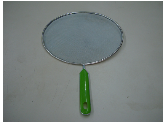
Imagen 16: Tamizador de 1 mm utilizado en el tamizaje de la muestra
