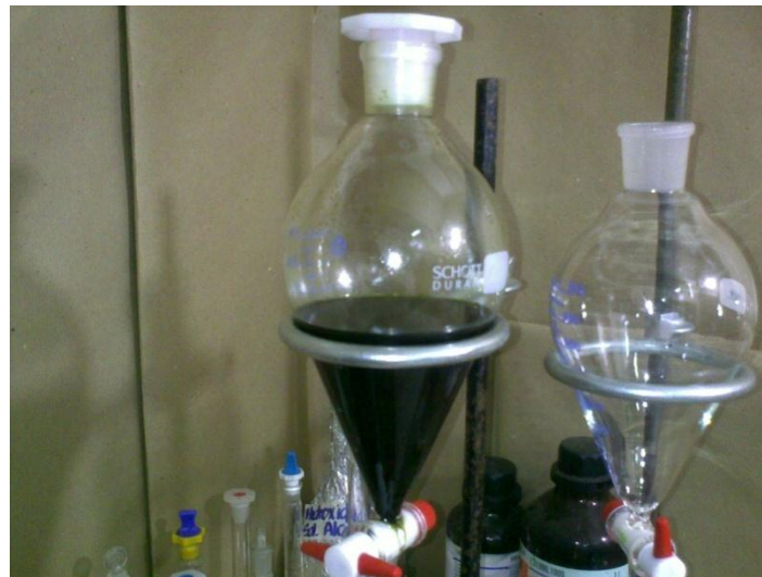
Fotografía 6. Fraccionamiento de los extractos etanólicos por medio de partición líquido-líquido con ampolla de decantación
