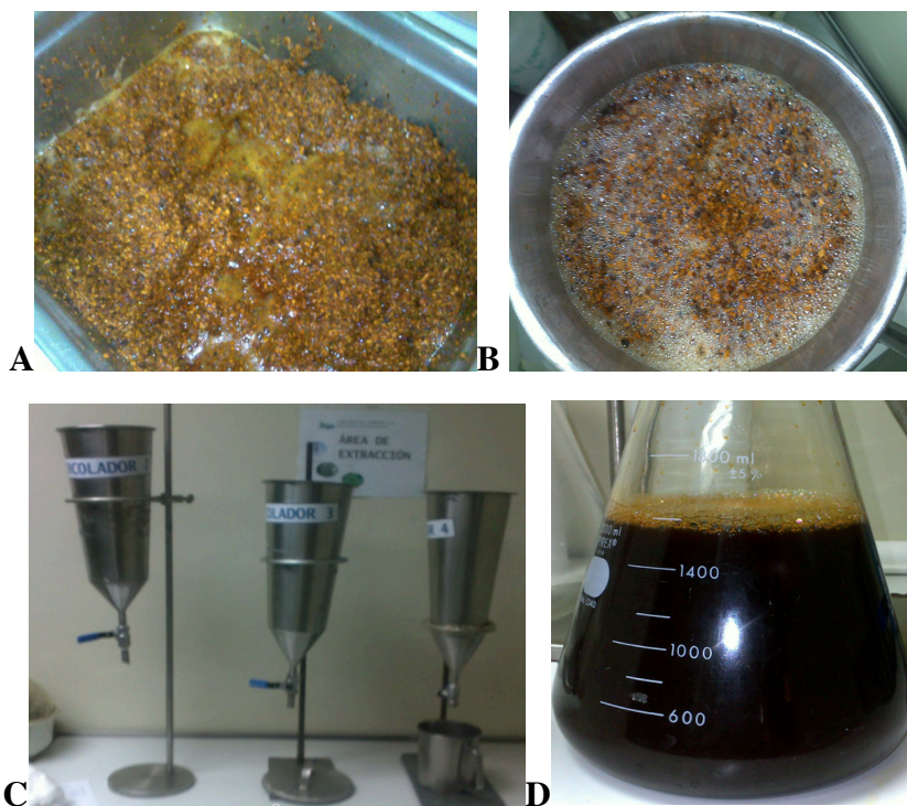
Figura 18. A. Humectación de zarparrilla. B. Zarparrilla ya humectada y cubierta con etanol al 50%. C. Sistema de repercolación. D. Extracto fluido 1:1 de zarparrilla
