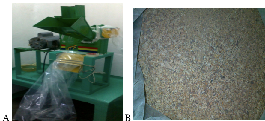
Figura 17. A. Molino de materia vegetal. B. Droga cruda molida
