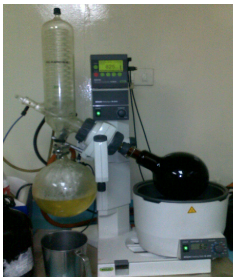
Figura 19. Concentración de solvente por medio de un rotavapor. Producto obtenido: extracto blando
