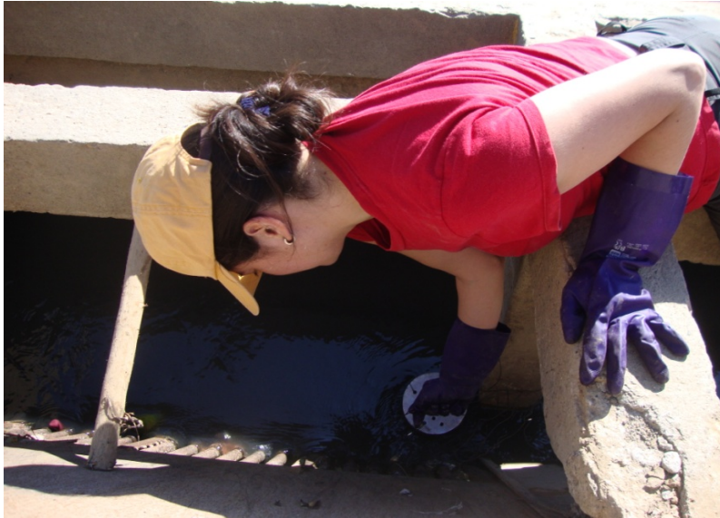
Figura 16. Colocación del muestreador pasivo (POCIS) y sujeción a una barrera de contención en el sitio de muestreo del río Villalobos
