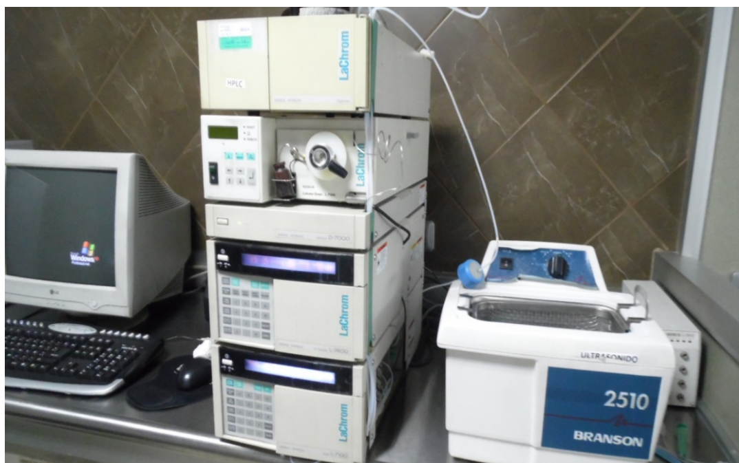
Figura 23. Cromatografo líquido de alta eficacia con detector ultravioleta utilizado para la determinación de contaminantes emergentes de tipo farmacéutico
