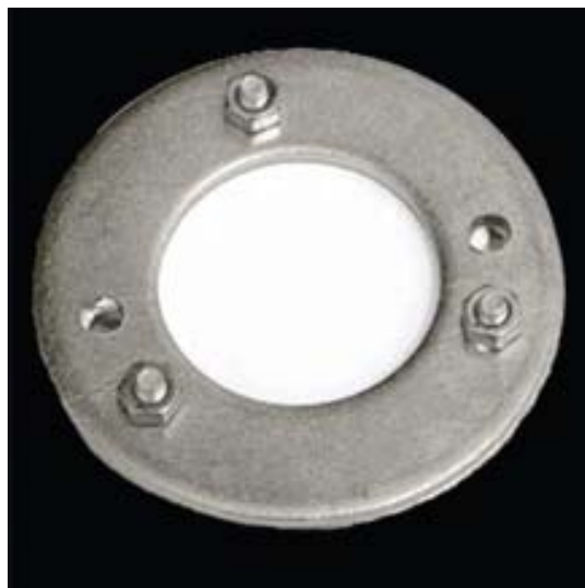
Figura 13. Dispositivo para el muestreo integrado de compuestos orgánicos polares - POCIS-
