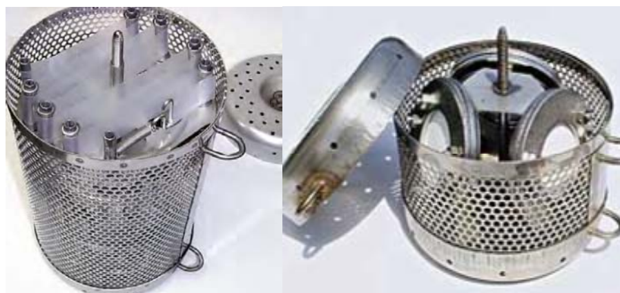
Figura 14. Canasta o contenedor de acero inoxidable para SPMD (a la izquierda) y para POCIS (derecha).
