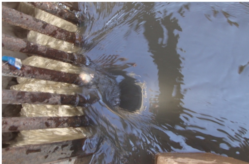
Figura 17. Muestreador pasivo sumergido a 20 cm de la superficie del agua en el sitio de muestreo del río Villalobos
