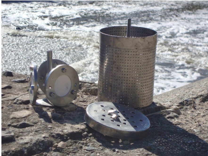
Figura 15. Muestreador pasivo con 3 filtros POCIS y canasta utilizados para la captación de contaminantes emergentes de tipo farmacéutico
