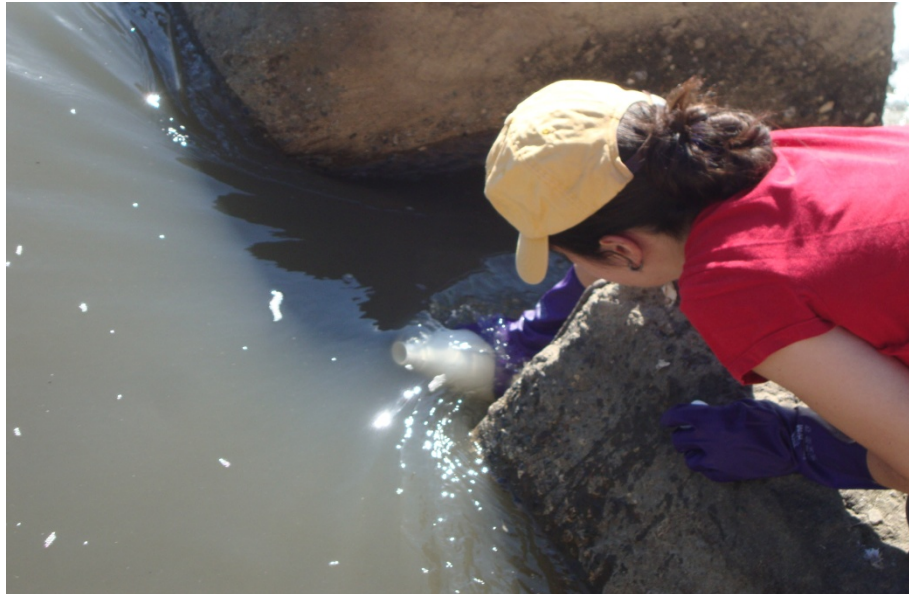
Figura 19. Toma de muestra de un muestreo compuesto puntual para el análisis de parámetros fisicoquímicos y para la cuantificación de contaminantes emergentes en el río Villalobos
