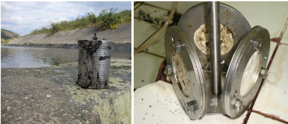
Figura 18. Canasta y filtros POCIS después de 30 días de exposición en el río Villalobos
