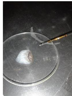
4° Colocar 1 ml de muestra en un vidrio de reloj y añadir 0.05 ml de yodo/yoduro de potasio
