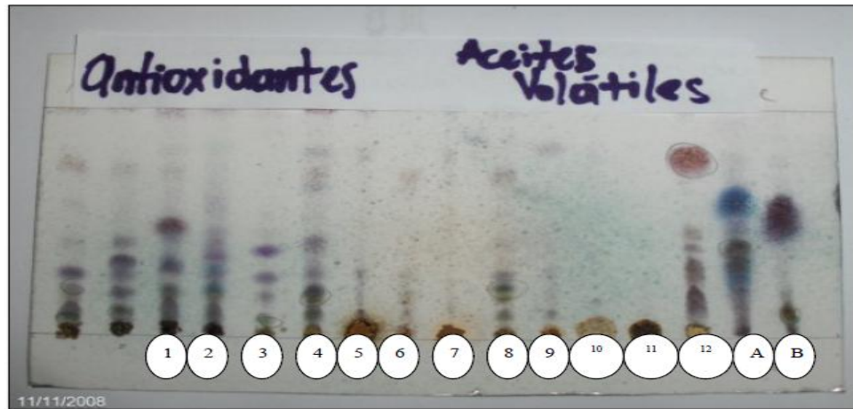
Figura 3. Cromatografía de capa fina para monoterpenos (aceites esenciales).
