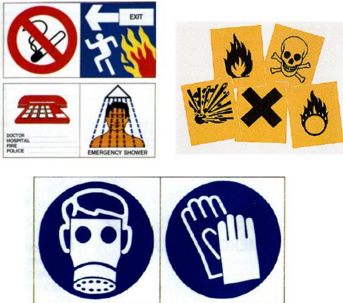
Figura No. 37: Ejemplos de símbolos de fácil entendimiento en señalización de lugares de almacenamiento y manejo de sustancias peligrosas.
