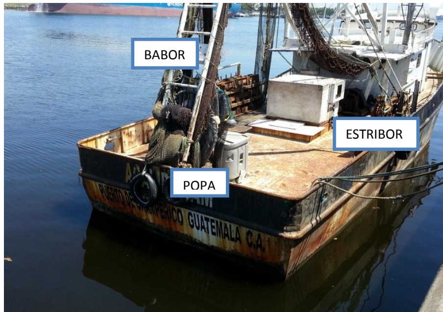
Figura 12: Partes de la estructura de un barco de camarón.
