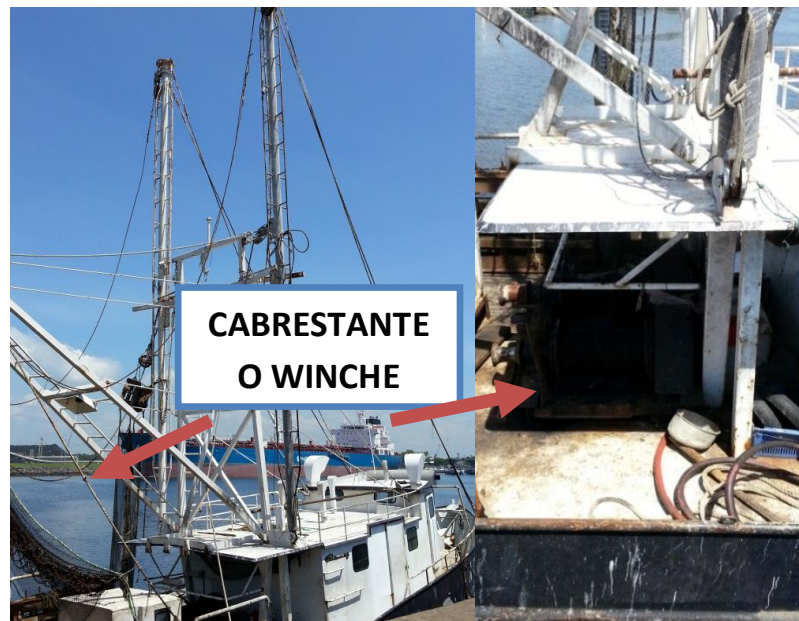
Figura 15: winche o cabrestante de un barco de camarón.
