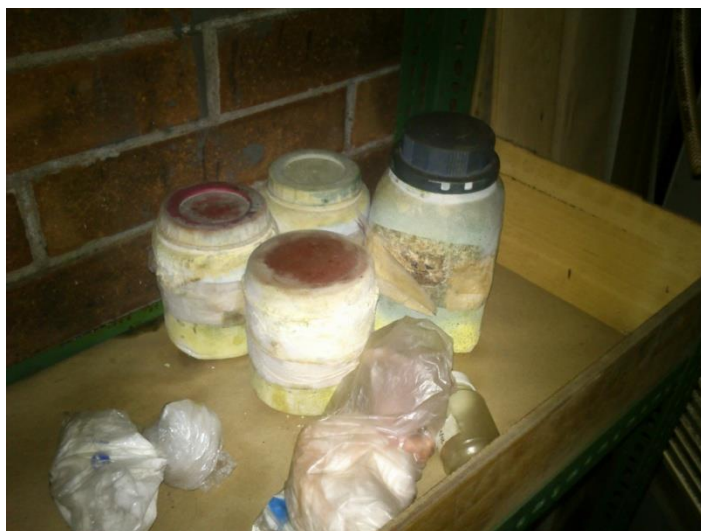
Imagen 15: Envases de almacenamiento de reactivos deteriorados
