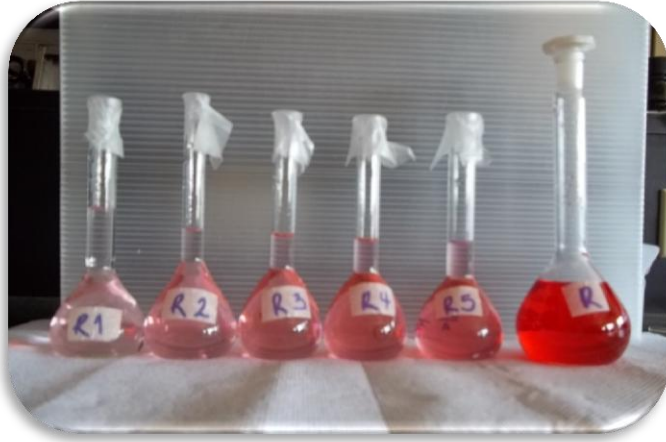
Figura No. c: Curva de calibración del estándar de colorante artificial Rojo No. 40
