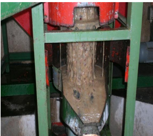
Imagen No. 10: Extracción con desmucilagadora
