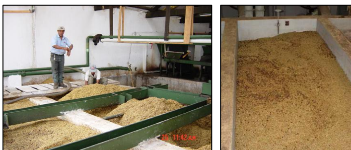
Figura No. 7: Piletas para fermentación natural del café, (IICA, 2010, p. 73)
