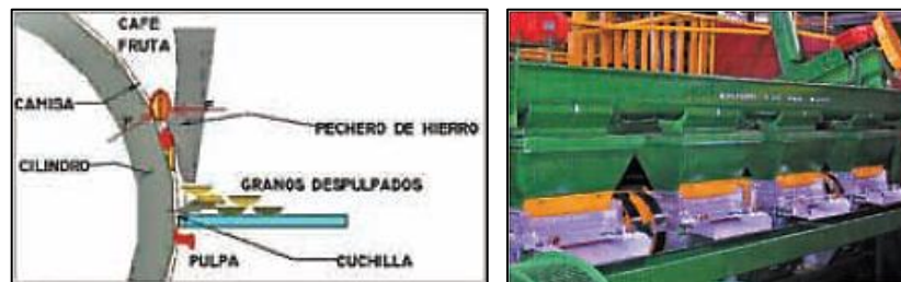
Figura No. 5: Proceso de despulpado del grano de café, (IICA, 2010, p. 38)
