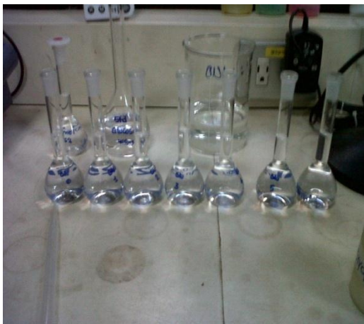
Imagen No. 7: Curva de Calibración azúcares
