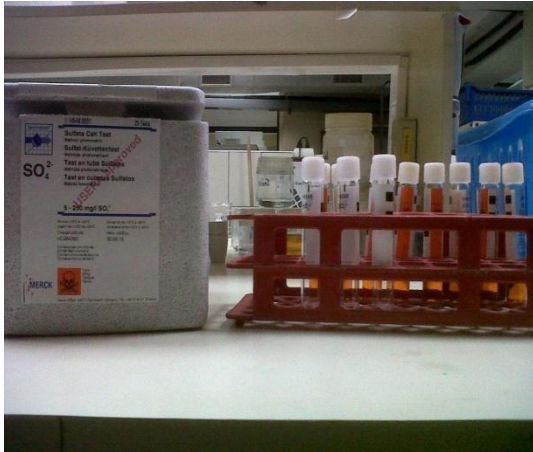
Imagen No. 5: Cuantificación de sulfatos con kit
