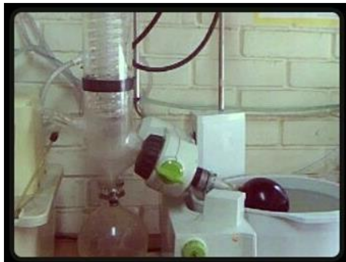
Fotografía 2. Concentración del extracto vegetal en rotavapor.
