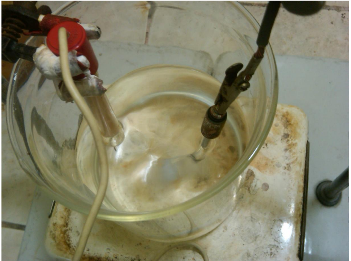
Figura 2. Sistema electroquímico visto desde arriba.
