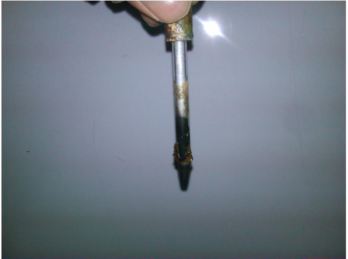
Figura 5. Electrodo de platino utilizado como cátodo después del proceso de electrolisis
