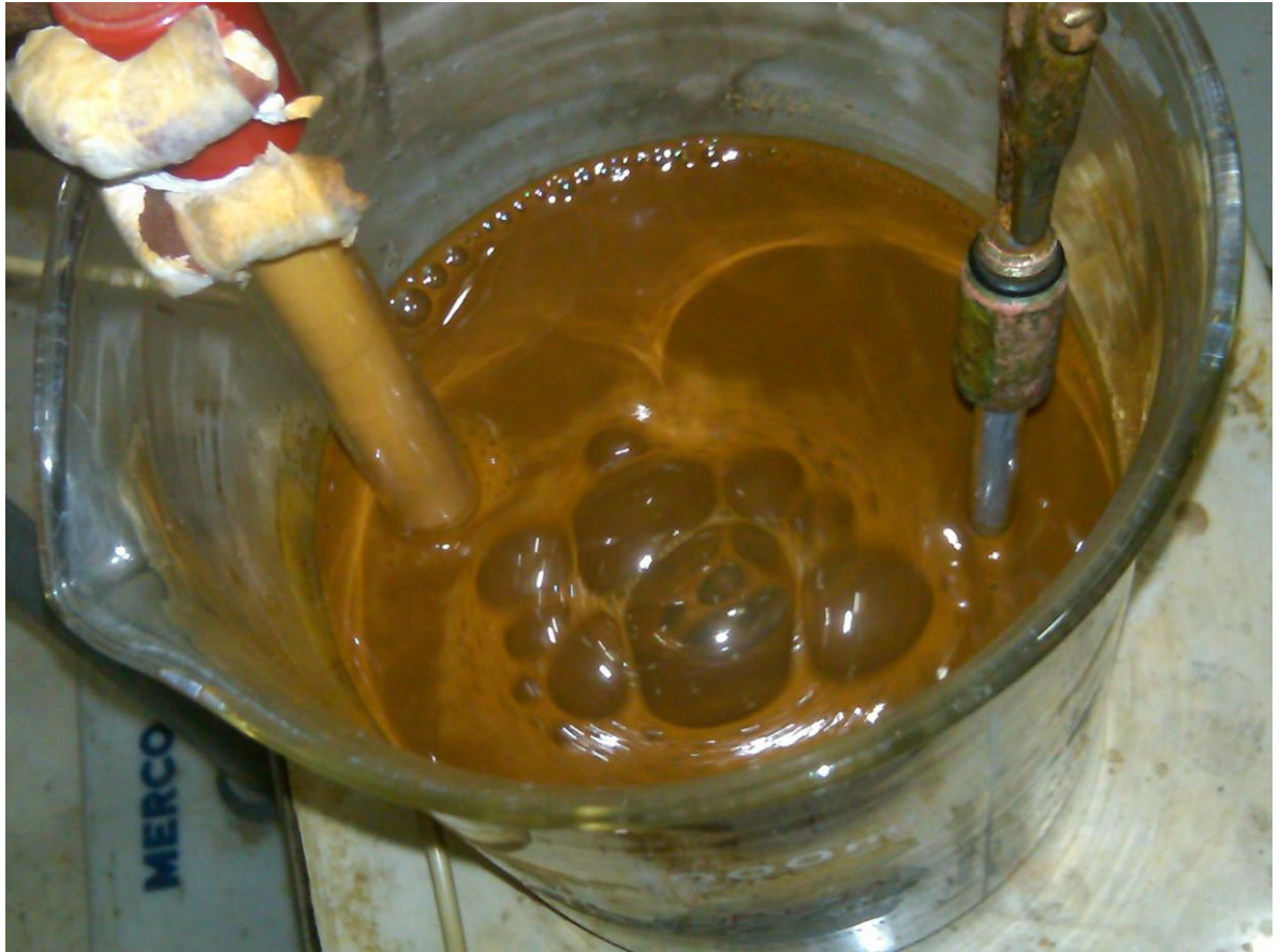
Figura 6. Formación de gases en el proceso de electrolisis
