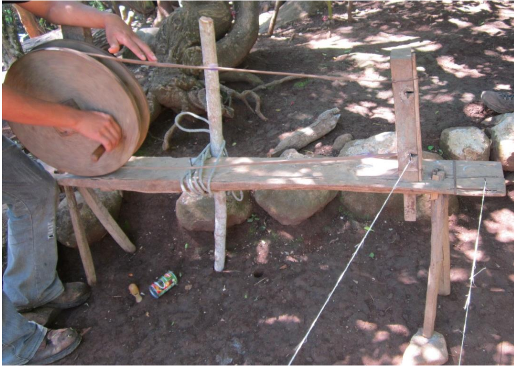
Imagen 1. Proceso de hilado de la fibra de maguey, San José, Comapa, Jutiapa, Guatemala
