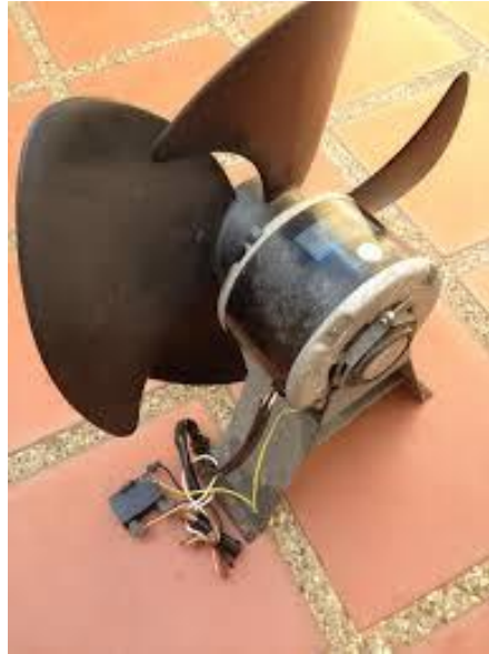
Figura 9. Ventilador de un condensador
