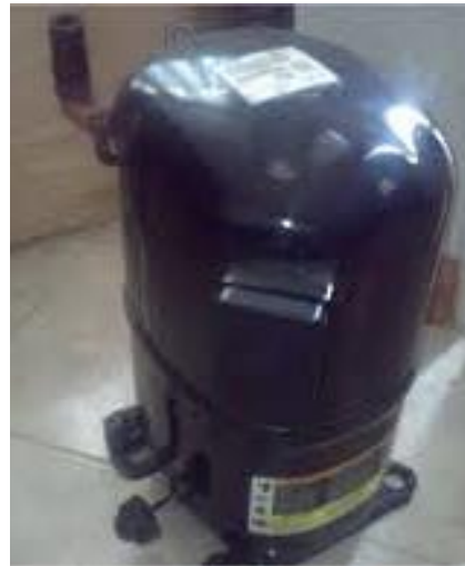
Figura 8. Compresor de equipo de aire acondicionado
