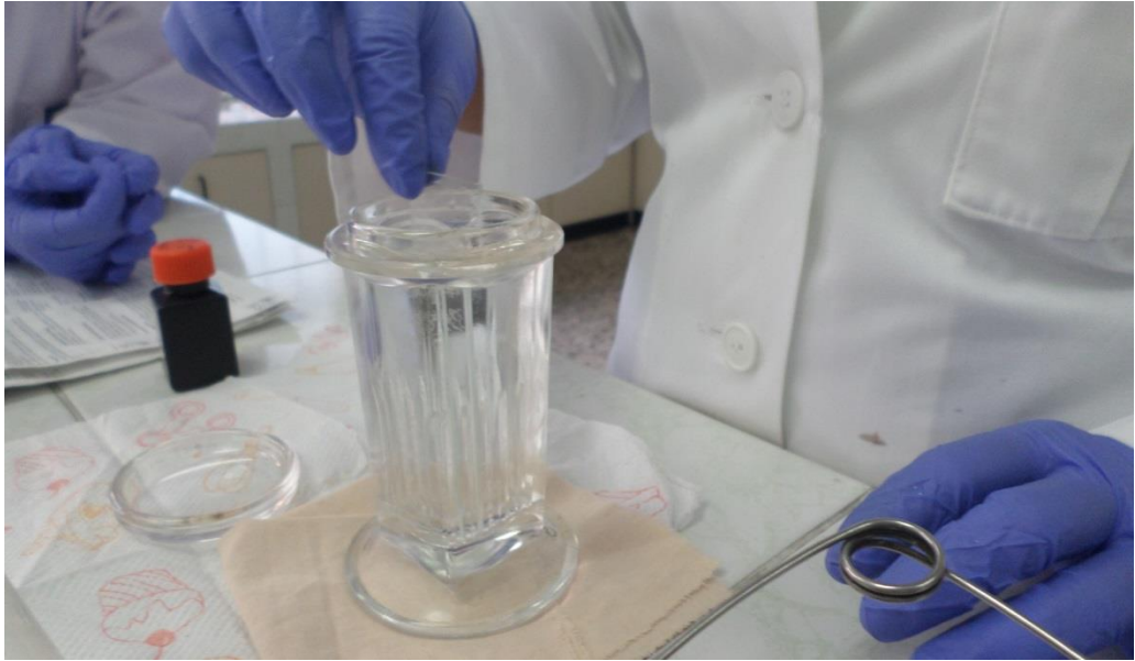
Fotografía 5. Colocación de las muestras en la cubeta con la solución de impregnación para luego incubarlas.
