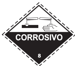
Figura No. 21 Pictogramas de sustancias químicas corrosivas
