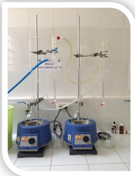
Imagen No. 3 "Extracción de aceite esencial a escala"
