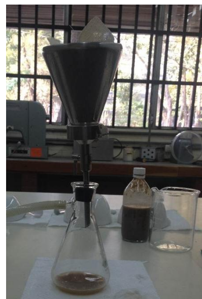
Imagen No. 7: filtración al vacío de mucílago
