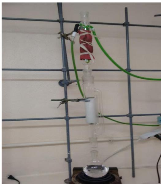
Figura No. 3 Extracción de aceite semillas por soxhlet
