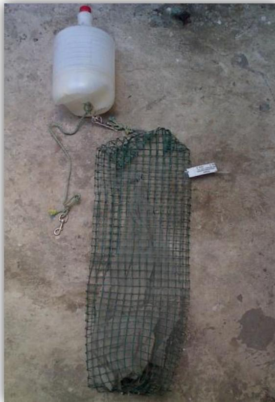
**Figura No. 3.** Colector de Columna de Agua (CCA) con la boya colocada.
