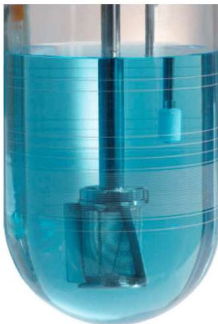
Figura No. 3.1: Aparato I USP (canasta)
