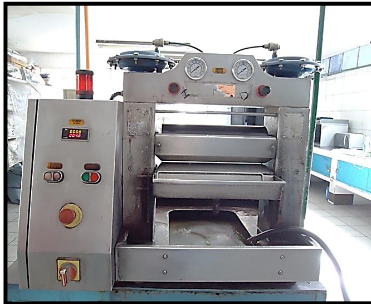
Figura No. 32 foulard ATAC para teñido continuo
