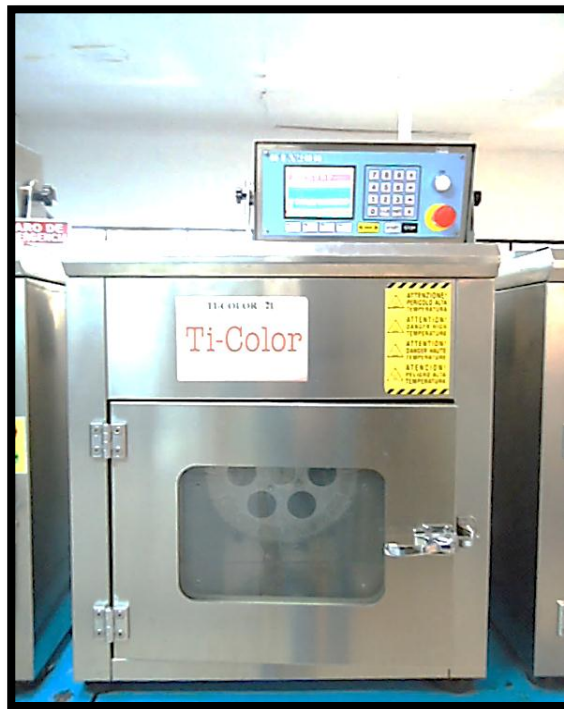
Figura No. 30 Máquina teñidora de madejas y tela Ti-Color
