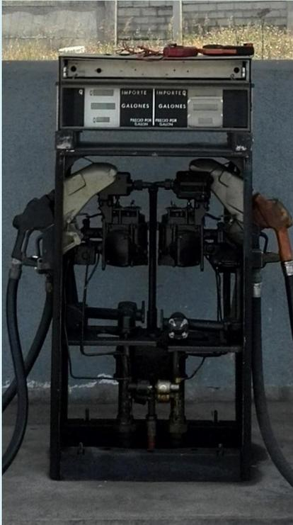
10. Preparar el área de trabajo, quitar tapaderas protectoras de la parte eléctrica, electrónica y mecánica del dispensador electrónico.
