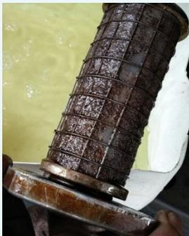
7. Cambio o limpieza de filtro de combustible; según aplique en marca y modelo de dispensador
