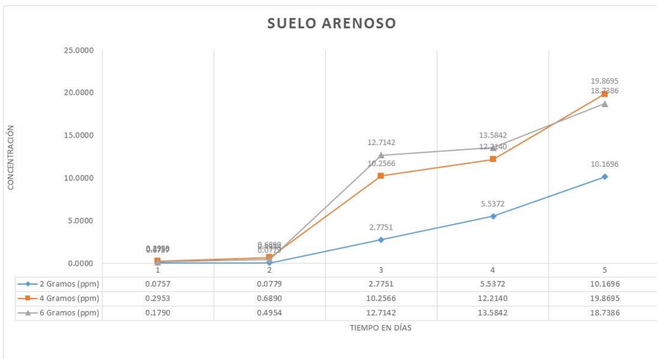
Gráfico # 1: Comportamiento de la liberación de fosfatos en suelo arenoso en diferentes dosis de hidrotalcitas fosfatadas.
