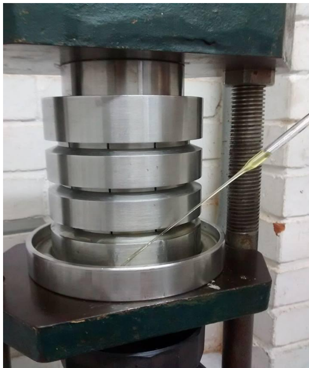
Figura No. 4 Extracción por expresión en frío del aceite de las semillas del güicoy
