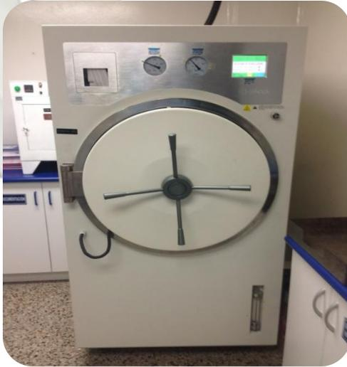
*Imagen 32 y 33: En las imágenes se puede observar la autoclave que se utiliza dentro del laboratorio de microbiología, se encuentra dentro del área principal pero actualmente se están modificando las áreas para tener un espacio específico para el autoclave. Se debe de tener un programa de revisión de empaques y válvulas dentro del programa de mantenimiento.*
