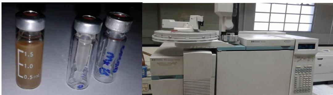
**Imagen No. 7** Identificación de azúcares por cromatografía de gases acoplado a espectrometría de masas
