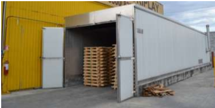
Figura 26. Capacidad del horno para tratamiento térmico
