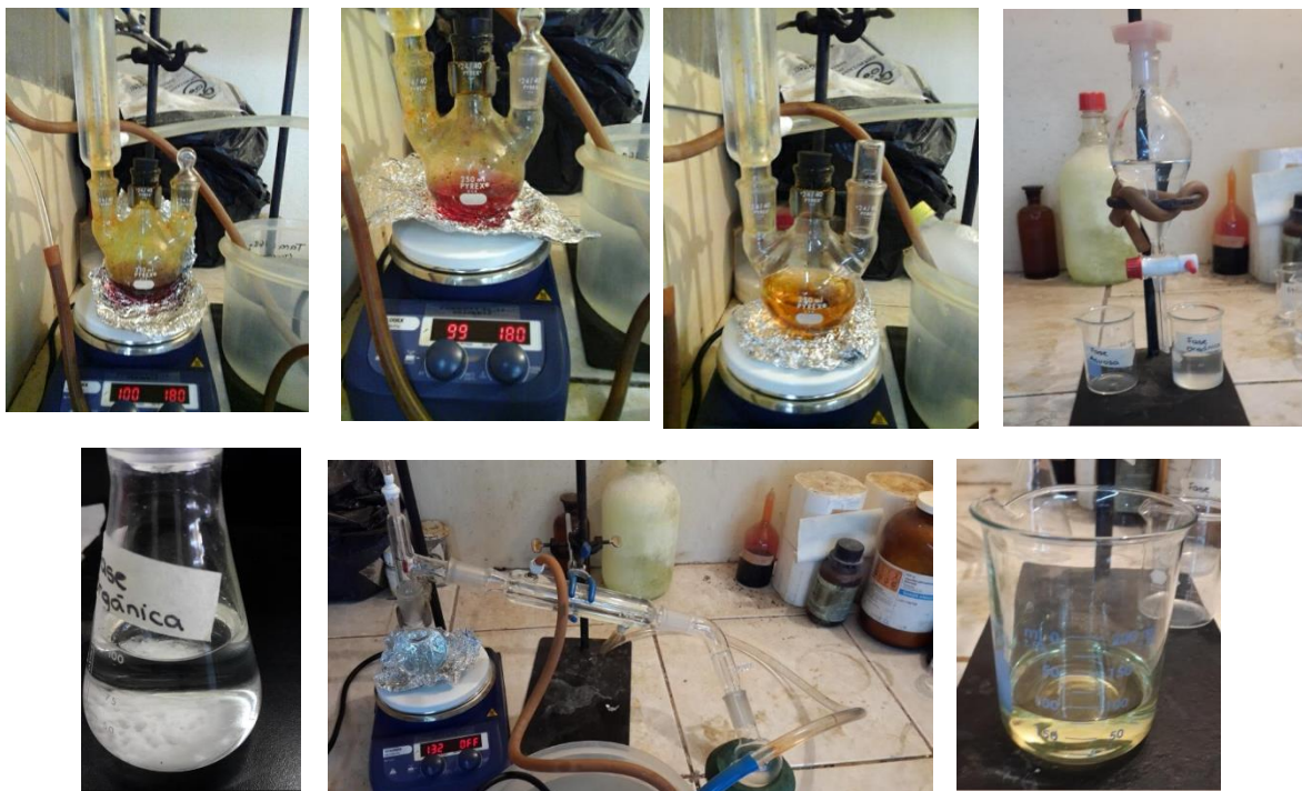
Serie de Imágenes 8: Características Presentadas en las Etapas de la Reacción de Hell-Volhard-Zelinsky con fósforo rojo purificado y sustitución nucleofílica con etanol
