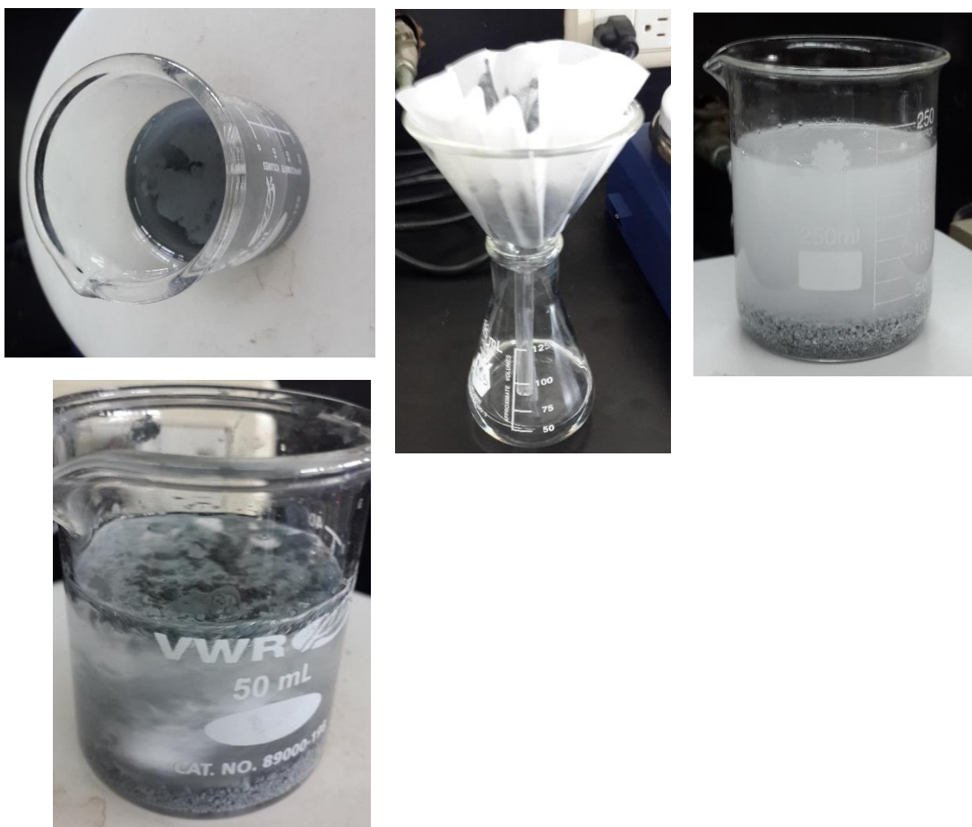
Serie de Imágenes 34: Activación del cinc, para las diferentes reacciones de Reformatsky
