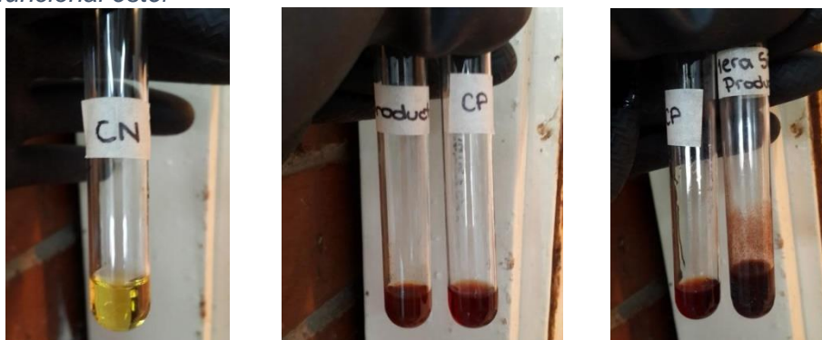
Serie de Imágenes 10: Prueba química del Ácido Hidroxámico para la identificación del grupo funcional éster
