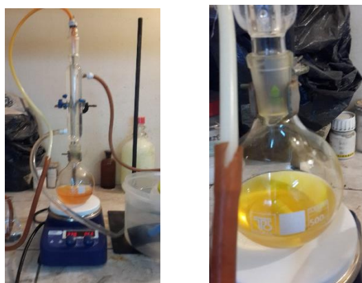
Serie de Imágenes 10: Prueba química del Ácido Hidroxámico para la identificación del grupo funcional éster
