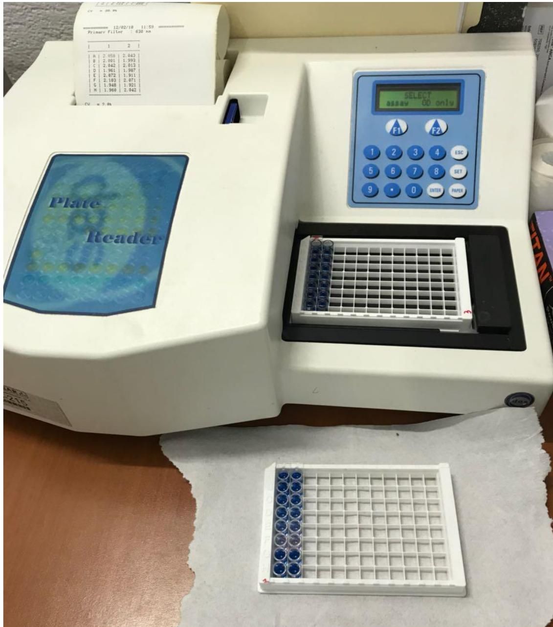
Para la lectura de las muestras se requirió de un espectrofotómetro, con una longitud de onda de 630 nm, para obtener las absorbancias respectivas
