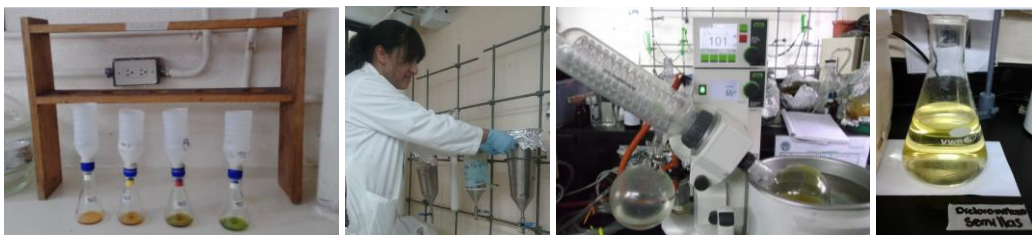
Prueba del mejor solvente extractor para extractos etanólicos, extracción en rotavapor y disolvente recuperado de percolador
