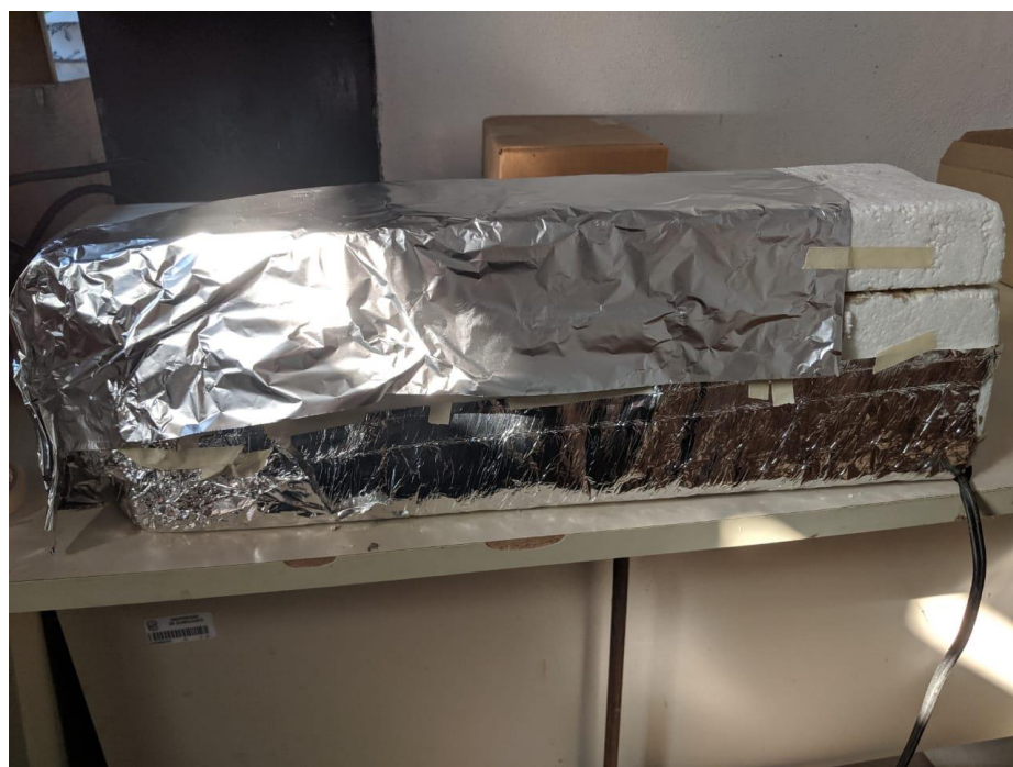
Figura 39: Proceso de Aislamiento de las Muestras de PDMSi para su Tratamiento UV.
