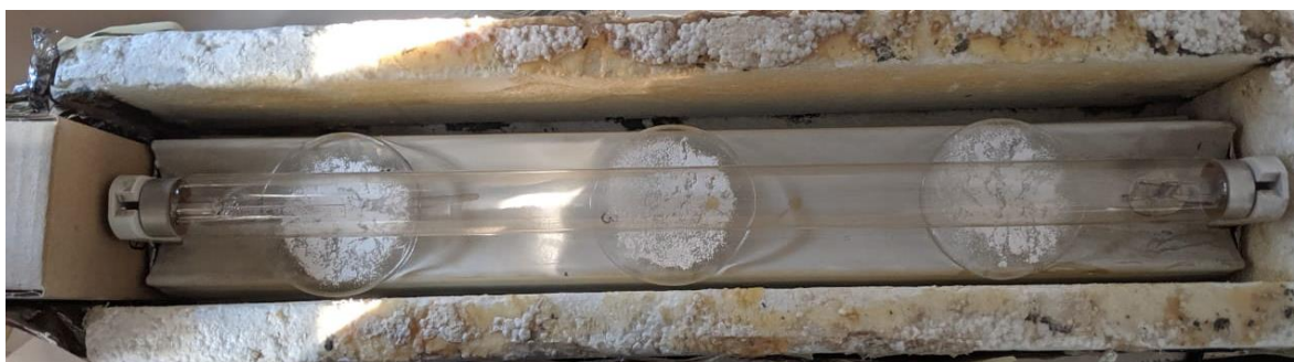
Figura 37: Procedimiento de Irradiación Inicial en fase sólida del PDMSi.
