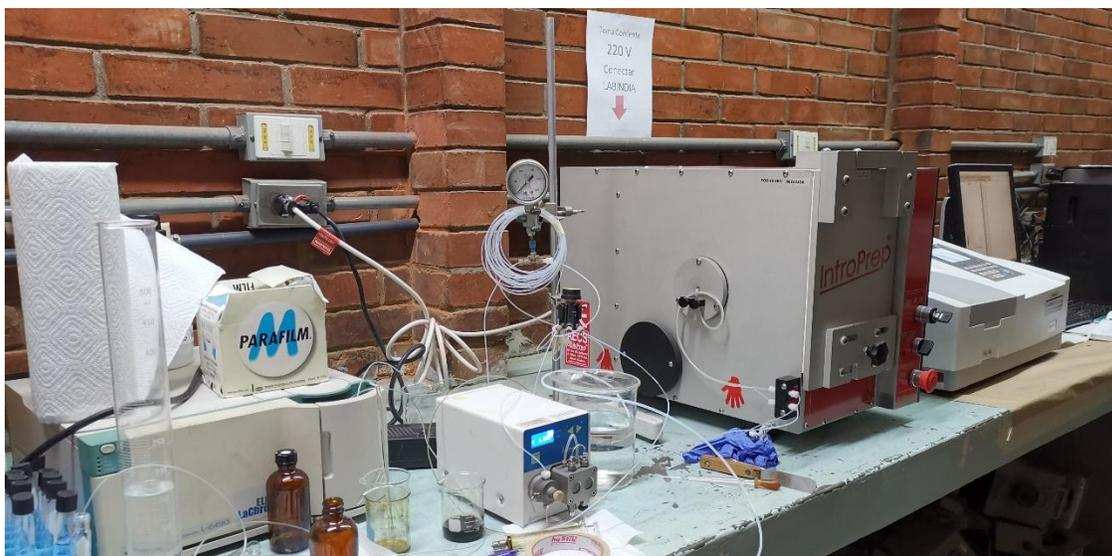
Figura 13. Cromatógrafo contracorriente (CCC) utilizado para el fraccionamiento de extractos alcohólicos crudos de *Tagetes lucida* Cav. y *Valeriana prionophylla* Standl. Fotografía tomada por Belter Trinidad en el laboratorio de Fisicoquímica.
