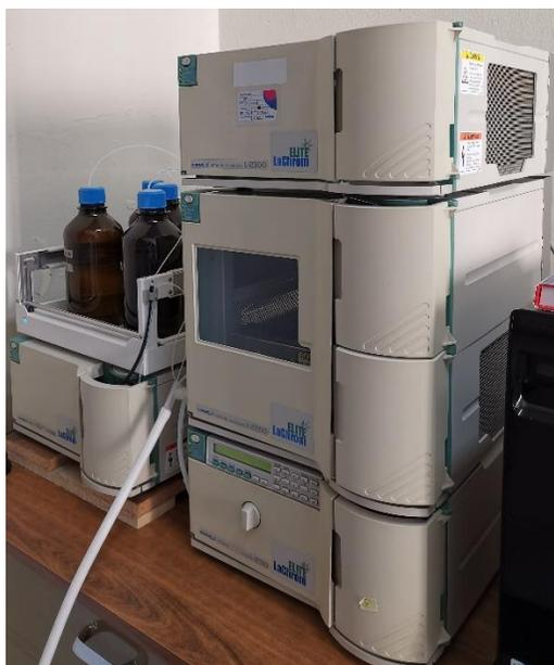
Figura 15. Cromatógrafo líquido de alta eficiencia con detector de arreglo de diodos (DAD) utilizado para la identificación de flavonoides en extractos alcohólicos de *Tagetes lucida* Cav. y *Valeriana prionophylla* Standl. Fotografía tomada por Belter Trinidad en Toxicología (CIAT).
