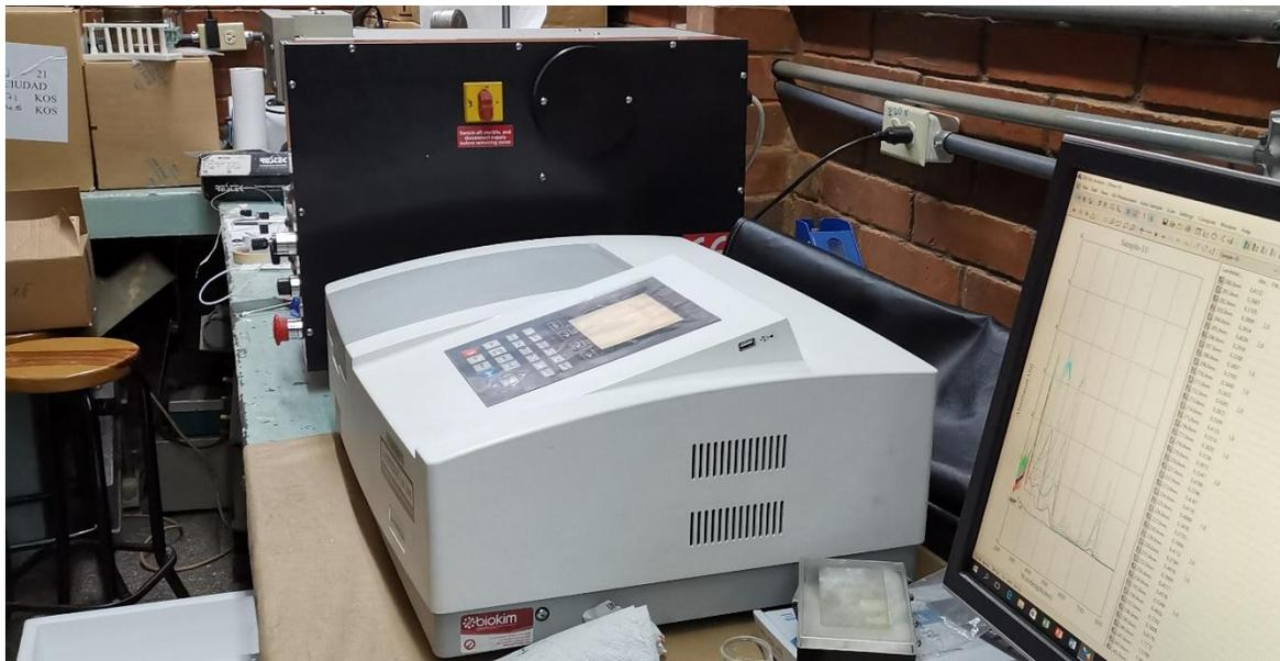
Figura 14. Espectrómetro UV utilizado para comparar los espectros de fracciones obtenidas por CCC. Fotografía tomada por Belter Trinidad en el laboratorio de Fisicoquímica.
