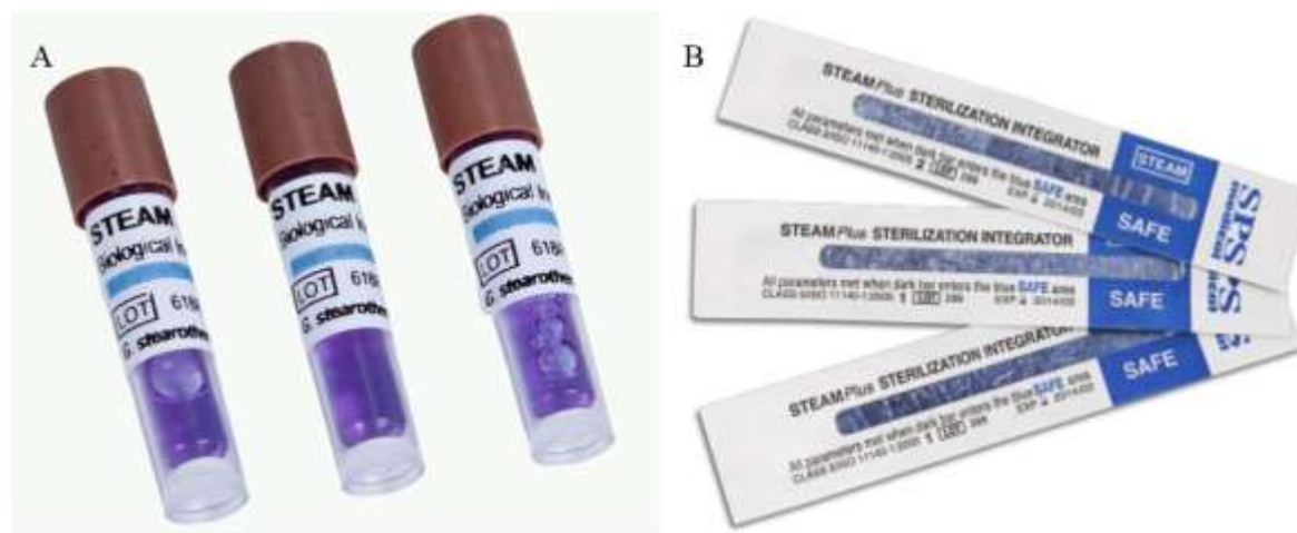
Figura 2. Indicadores biológicos y físicos para la verificación de la efectividad de la esterilización. A. Ampollas con G. stearothermophilus . B. Cinta para verificación de temperatura y tiempo (Acosta-Gnass & Andrade, 2008).
