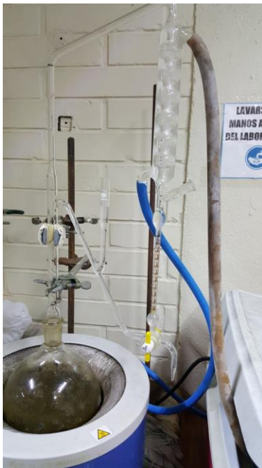
Figura 22: Fotografía de aparato de hidrodestilación Clevenyer utilizado.
