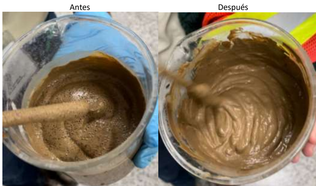
Anexo 15: Síntesis de OVerM antes y después de ser sometido a ultrasonido por 24 horas.
