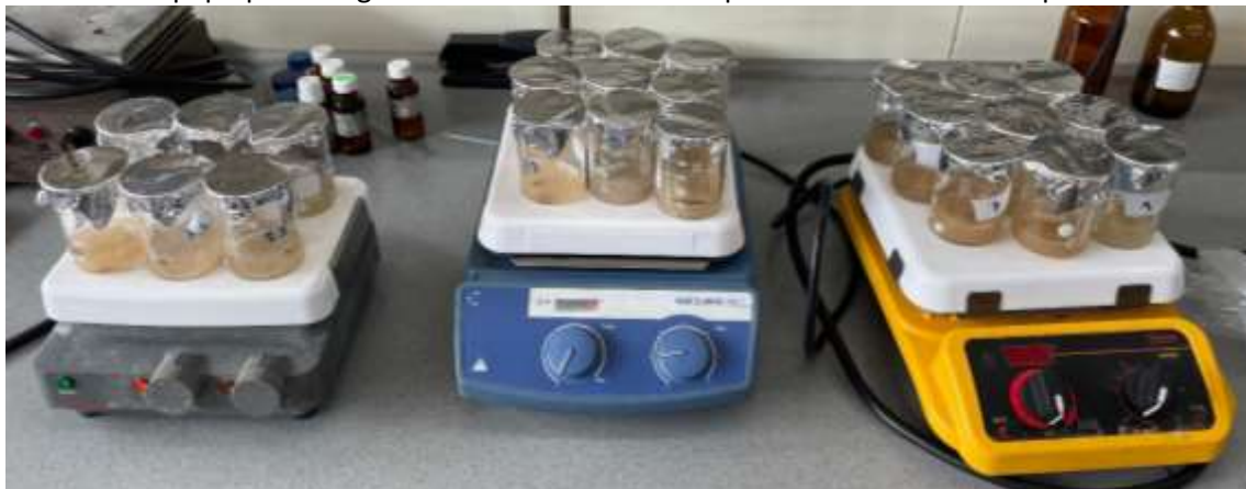
Anexo 18: Equipo para la agitación de las arcillas con cipermetrina a diferentes pH.
