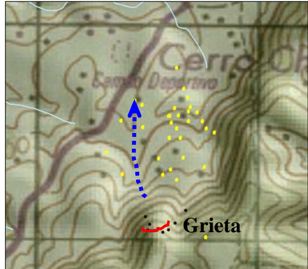
Figura 2. Detalle del Sector Cuatro de Santa Rosa Chujuyub en donde se muestra la grieta que se ha activado en fecha reciente. Las viviendas del sector, se indica en los puntos de color amarillo y la posible direcci6n de flujo se indica con l6nea punteada
