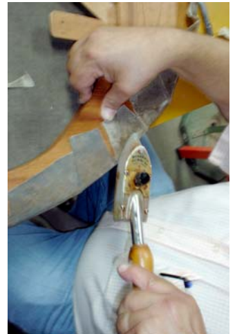
Fijado de dobleces con termo-sellador
