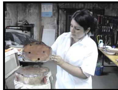
Perdida de adherencia del adhesivo utilizado
