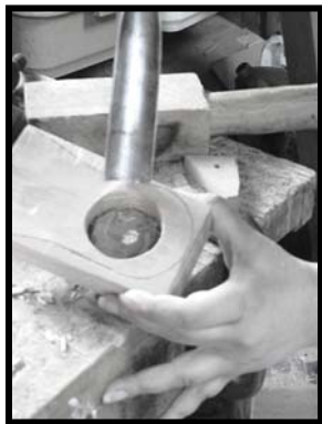
Elaboración del alza que sustituirá la pasta que tenía anteriormente, para colocar el pie izquierdo en la peaña y dejarlo a nivel
