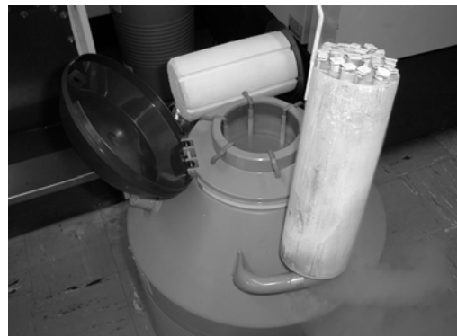
Figura 29. Almacenamiento en nitrógeno líquido. Implementos requeridos: termo, canastilla, cañas y viales (Sánchez y Royse, 2002).
