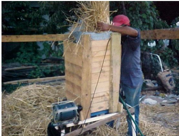
Figura 50. Picadora de paja construida a partir de una cortadora de césped (Cisterna, 2002).
