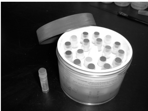
Figura 28. Contenedor cryogénico para enfriamiento controlado y viales cryogénicos para el nitrógeno líquido (Sánchez y Royse, 2002).
