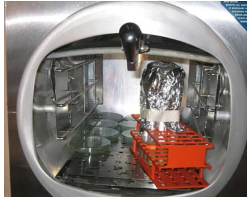
Figura 22. Tubos de ensayo con medio de cultivo y tapones cubiertos con papel aluminio para esterilización en autoclave
