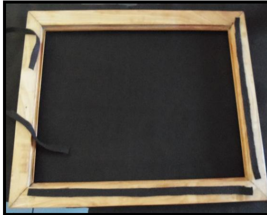
Figura 40. Colocación de fieltro para protección
