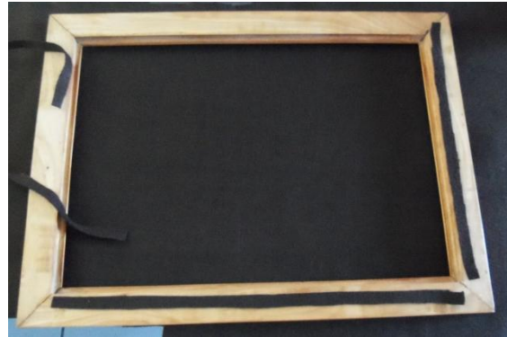
COLOCACIÓN DE TELA AL MARCO, PARA EVITAR QUE SE ASTILLE EL VIDRIO O EL MARCO
