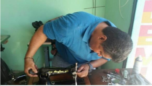
Foto 6. Probando la barra del tensor de la máquina.
