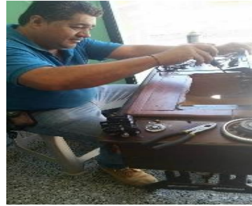
Foto 7. Revisando la caja de garfio y bobina.
