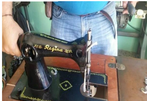
Foto 5. Técnico desarmando la máquina para limpiar la polea.
